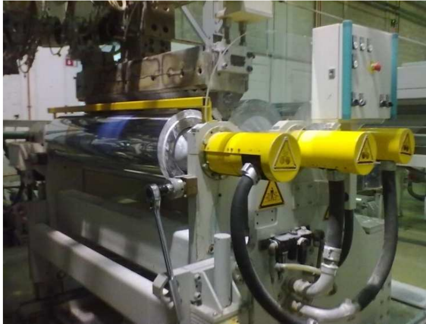
Figura 8.3. Dado y calandrias. Los tres rodillos tienen un sistema de refrigeración por medio de agua.
