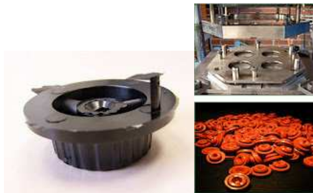
Figura 5.4. Piezas producidas mediante moldeo por transferencia a) Perilla y b) Molde y Tapones de caucho
