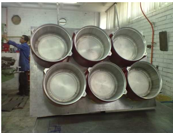
Figura 6.6. Domo para pastel .Ensamble de cavidades, suajes en placa de sujeción.
