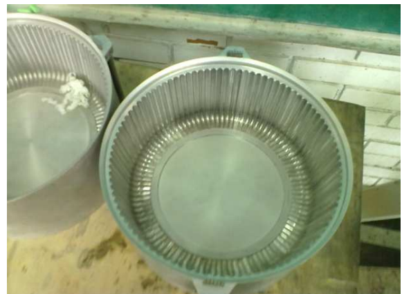
Figura 6.7. Cavidad o molde de aluminio.
