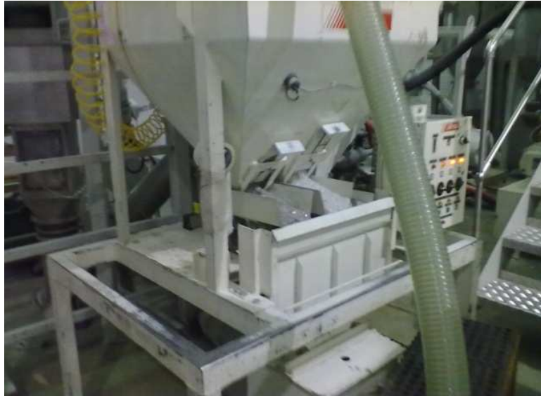
Figura 8.1. Tolvas de alimentación.
