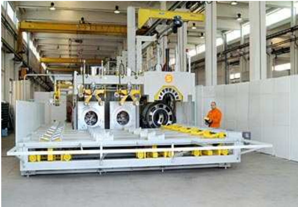
Figura. 7.14. Acampanador y abocinador de tubería
